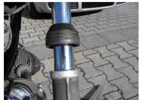
Wenn unter der Staubkappe oder auf dem Gabelholm Öl zu bemerken ist, ist der Dichtring schadhaft und muss ausgetauscht werden.
