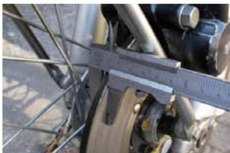
Mit dem Messschieber wird die Höhe der Bremscheibe gemessen.
